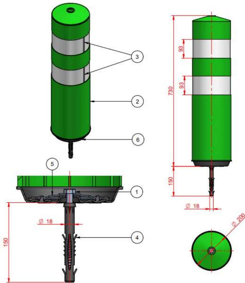
Baliza tipo H75 flexible, resistente al atropello. Cuerpo en EVA flexible, recupera la forma tras un aplastamiento. Disco de acero galvanizado espesor 2mm remachado a la base en ocho puntos. Anclaje compuesto por un taco de expansión de  $\varnothing 18\text{mm}$  x 150mm y un tornillo de anclaje M12 en acero tipo DIN 571. Revestimiento: Dos bandas de film Clase 2 o Clase 3 prismático, flexible
